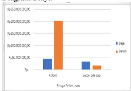
Dari diagram biaya di atas diperoleh untuk pekerjaan kolom beton lebih besar biayanya di dibandingkan dengan kolom baja, dan untuk beton pile cap baja lebih tinggi di dibandingkan dengan beton.
