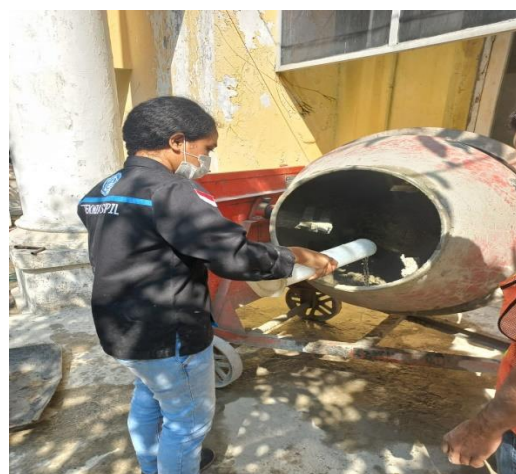
Gambar 1. Proses Pembuatan Benda Uji (SCC)
