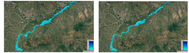
Gambar 20. Reduksi Banjir Bendung Karet Mengembang Q50 Tahun
