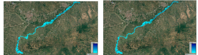
Gambar 24. Reduksi banjir bendung karet mengempis Q100 tahun
