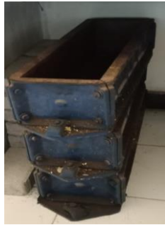
Gambar 1. Alat Cetak Pembuatan Balok Beton Ukuran 150 mm x 150 mm x 600 mm Sumber: Dokumentasi Laboratorium (2020)
