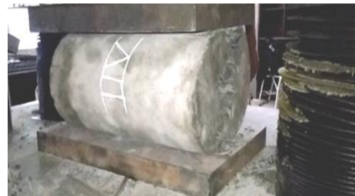
Gambar 3. Uji Tari Belah Beton
