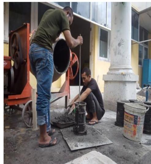
Gambar 4. Campuran dalam silinder dengan menggunakan rojokan
