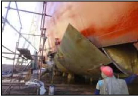
Gambar 3. Pemotongan Pelat Kapal
