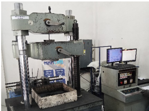
Gambar 5. Alat Uji Tarik Produsen Tulangan Sumber: Dokumentasi Pribadi
