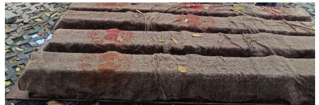
Gambar 7. Perawatan Curing Benda Uji Balok Sumber: Dokumentasi Pribadi
