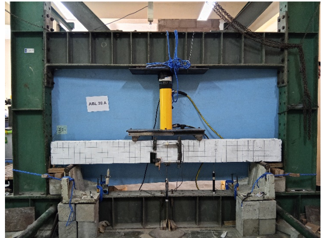
Gambar 10. Pengujian Balok Lentur Sumber: Dokumentasi Pribadi
